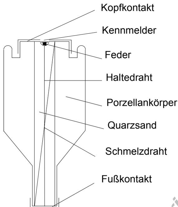
Steigt die Stromstärke in einem Stromkreis über einen bestimmten Wert hinaus, schmilzt ein im Inneren des Keramikkörpers befindlicher Draht. So wird der Stromkreis unterbrochen.
