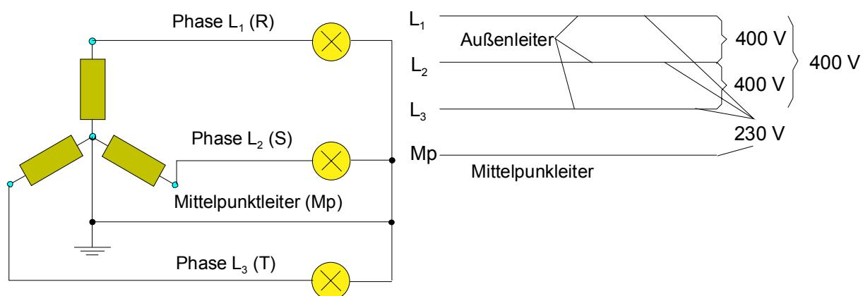
Die Vorteile des Drehstromnetzes bestehen darin, man hat mit vier Leitern zwei verschiedene Spannungen ( $3 \cdot 400\text{ V}$  und  $3 \cdot 230\text{ V}$ ) zur Verfügung. Drei gleichstarke Verbraucher (symmetrische Belastung) können an nur drei Leitungen, den drei Phasen oder auch Außenleiter genannt ohne Rückleitung angeschlossen werden. Hat man ungleiche Verbraucher (asymmetrische Belastung), so ist der Mittelpunktleiter Ausgleichsleitung für den Strom.
