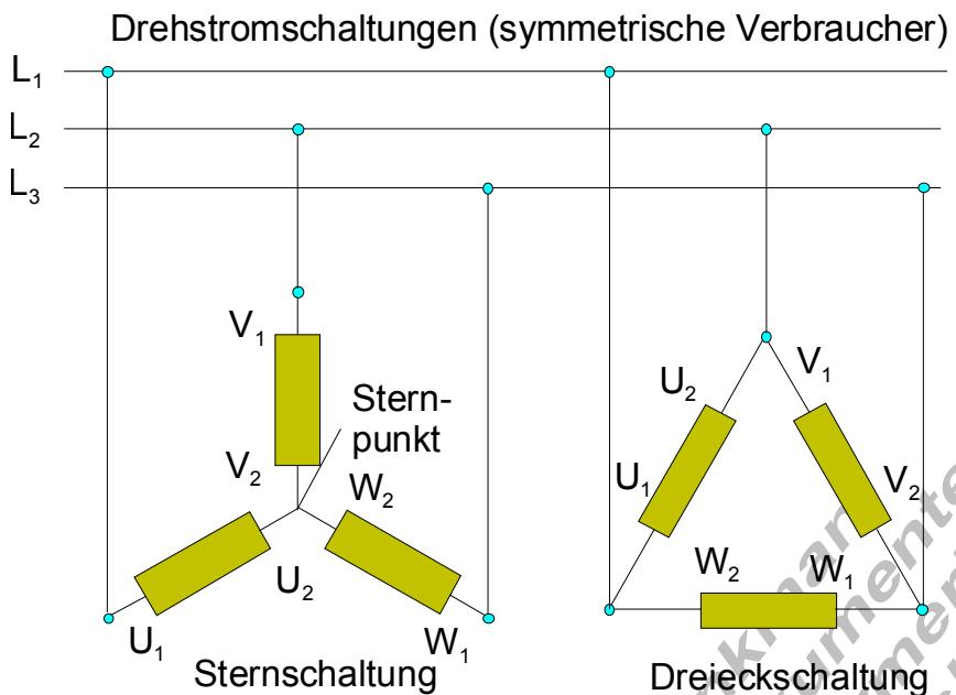
Es gibt zwei verschiedene Schaltungen, wie Verbraucher an ein Drehstromnetz angeschlossen werden können. Die Sternschaltung und die Dreieckschaltung. Bei der Sternschaltung hat jeder Verbraucher die Spannung 230 V. Bei der Dreieckschaltung hat jeder Verbraucher 400 V.
